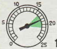
INDICAZIONE NORMALE. NORMALI CONDIZIONI DEL MOTORE.
