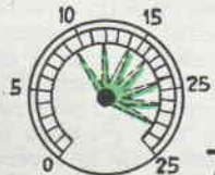
RAPIDE VARIAZIONI DI INDICAZIONE, SOTTO L'ACCELERAZIONE, INDICANO UNA MOLLA ROTTA
