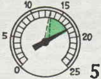
ESCURSIONE DI AMPIEZZA NORMALE MA IN ZONA ARRETRATA DEL QUADRANTE. VALVOLE CHE NON APRE BENE.
